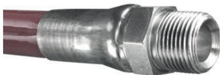
Manguera Piranha® de alta presión (250 bar) para limpieza de cloacas, fabricada con un tubo interno de poliolefina amarilla, dos trenzas de fibras sintéticas de alta tracción y una cubierta de poliuretano granate resistente a la abrasión. La cubierta es tipo Slither® con bajo coeficiente de fricción, lo que permite utilizar las mangueras en cloacas con codos complicados.
