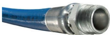
Manguera Piranha® de alta presión (200 bar) para limpieza de cloacas, fabricada con un tubo interno de termoplástico amarillo sin costuras, refuerzo trenzado doble de fibras sintéticas de alta tracción y una cubierta de poliuretano azul resistente a la abrasión. La cubierta es tipo Slither® con bajo coeficiente de fricción, lo que permite utilizar las mangueras en cloacas con codos complicados.
